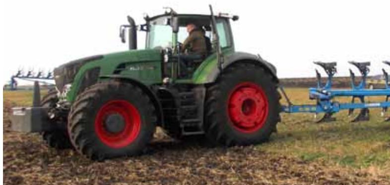
продаж Пензенского филиала «АгроЦентраЗахарово». — По полю идет плавно и равномерно. Если вдруг тяговая нагрузка на трактор увеличивается, трансмиссия Vario, в свою очередь, автоматически увеличивает обороты двигателя. Как только сложный участок пройден — Vario самостоятельно сбрасывает обороты, возвращая нагрузку на двигатель в обычный режим. Прохо-
