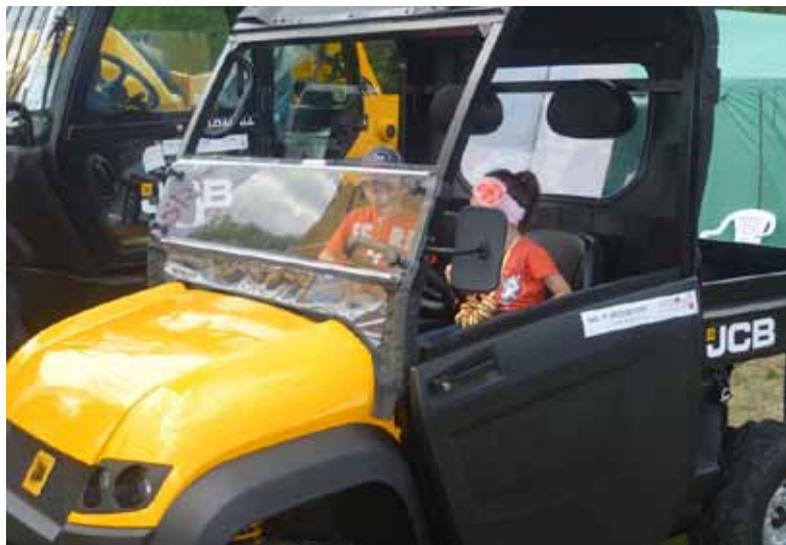
лись и взрослые, и дети. Эти грузовики оснащены трехцилиндровыми дизельными двигателями Yanmar мощностью 14,9 кВт, весят 710 кг и обеспечивают общую грузоподъемность 600 кг.
