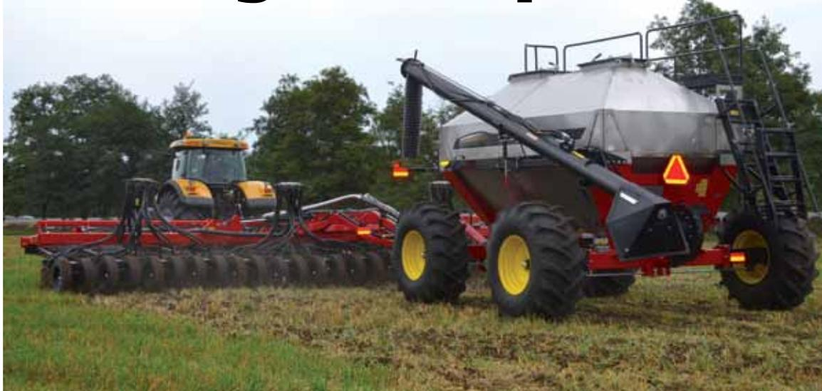
почва попадает под прикаты-вающие колеса, которые заделывают ее в борозду, формируя уплотненное семенное ложе. Точность высева остается постоянной даже при работе на высокой скорости. Если заделка семян идет с одновременным внесением удобрений, то они располагаются посередине между 15-сантиметровыми бороздами без необходимости дополнительных регулировок или изменения
