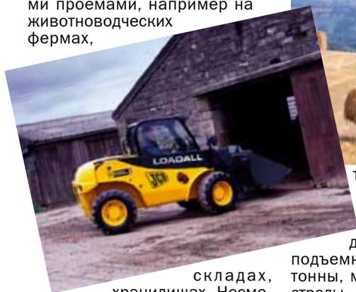
складах, хранилищах. Несмотря на компактность, погрузчик сочетает в себе характеристики и функциональные возможности известных универсальных телескопических погрузчиков JCB с боковым размещением двига-
