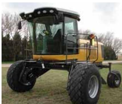
Новая самоходная косилка Challenger WR9740 пришла на смену известной косилке SP115C, зарекомендовавшей себя одной из лучших машин в заготовке кормов. Высококачественный питательный корм – результат WR9740. Машина предназначена для скашивания травяных, зерновых и зернобобовых культур. Также WR9740 используется для уборки зерновых культур по раздельной технологии.
